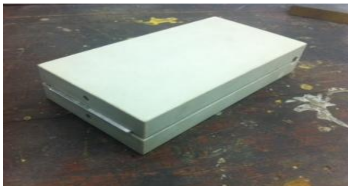
Fig. 2.4. Forma de PVC que será usada para fazer os enrolamentos no núcleo AMCC 1000.
