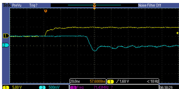
Fig. 4.10. Pulsos de saída (azul) e de gatilho (amarelo) mostrando o tempo de fechamento da chave em 10 ns. Escala horizontal: 20 ns/div; escala vertical: CH1- 5V/div e CH2-500 V/div.
